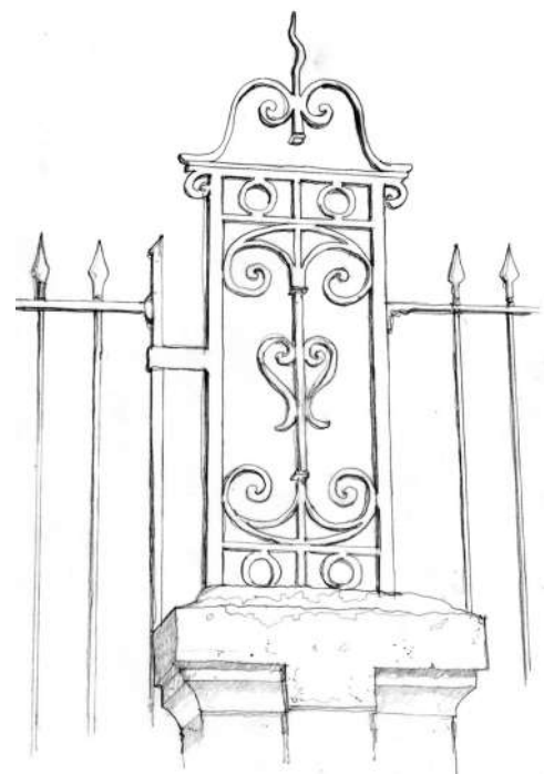
Mur-bahut et grille en acier peint. Une solution ancienne (XVIII e siècle) qui permet de choisir entre voir le bâti ou préserver l'intimité du jardin avec végétation ou dispositifs d'occultation.
